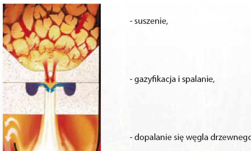
Rys 6.1. Spalanie pelet drzewnych. Pelety przechodzą najpierw suszenie i spalanie, wtedy postaje płomień. Następnie dopalany jest węgiel drzewny, pozostawiając popiół.
