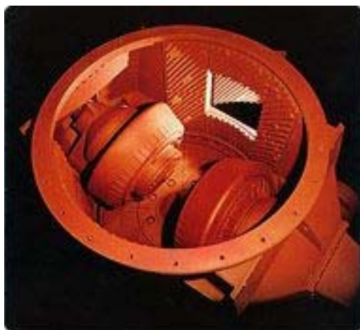
Rys. 12.3. Zdjęcie młyna węglowego oraz jego schemat – wydajność młyna 180 ton/godzinę.
