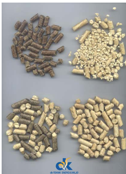
Rys. 4.2. Cztery różne rodzaje pelet, różniące się między sobą jakością. Pelety znajdujące się w dolnym prawym rogu to pelety wysokiej jakości, o niskiej zawartości popiołu, wyprodukowane z czystego i suchego drewna. Pelety w dolnym lewym rogu to mieszanka wyprodukowana z dwóch różnych rodzajów surowca. Spalanie takiej mieszanki doprowadziło do powstania szlaki w kotle w związku z niższą temperaturą topnienia popiołu. Ciemne pelety w górnym lewym rogu doprowadziły do powstawania porowatego żużla, który zablokował przenośnik śrubowy, służący do usuwania popiołu. Pelety w górnym prawym rogu cechuje wysoka zawartość pyłu. Doprowadziły do powstania blokady w systemie zasilania paliwem, co skutkowało niską wydajnością procesu spalania.
