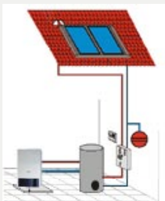
Schemat instalacji solarnej z kotłem kondensacyjnym
