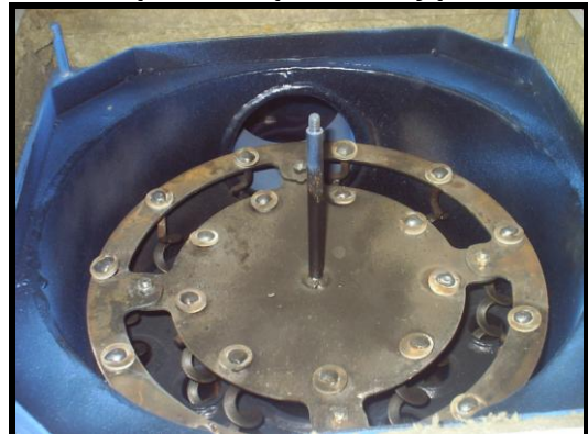
6. Odkręcić nakrętki mocujące
