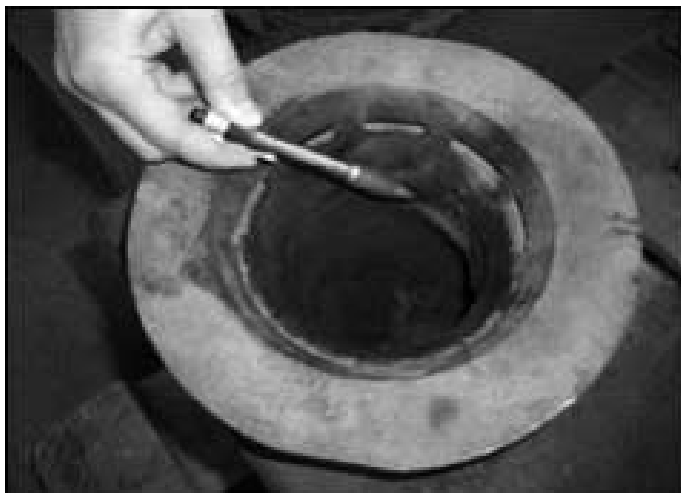
Czyszczenie nagaru z kolana palnika (wyłącznie przy paliwie pellets)
