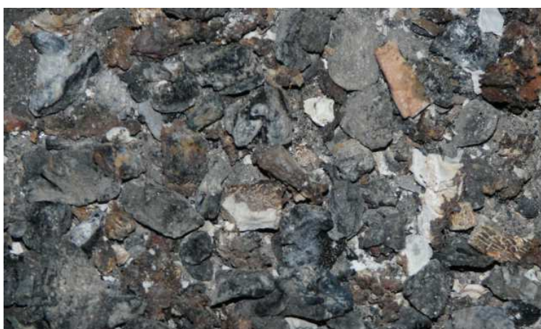
Rys. 25. Spiekanie węgla – niepoprawna regulacja palnika względem jakości paliwa.
