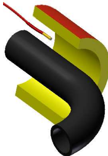
Rys. 9. Montaż czujników temperatury
