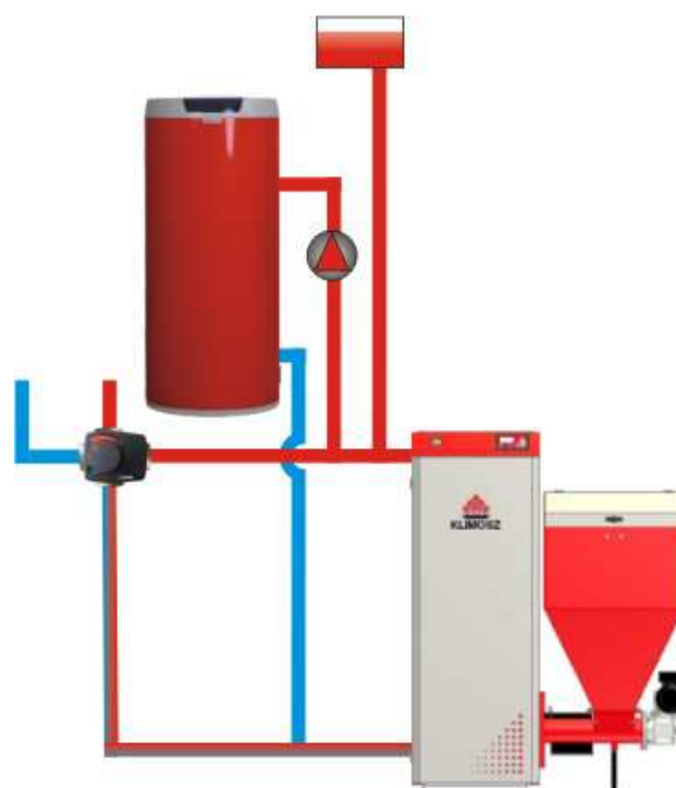
Rys. 27. Układ ogrzewania w trybie LATO – tylko c.w.u.
