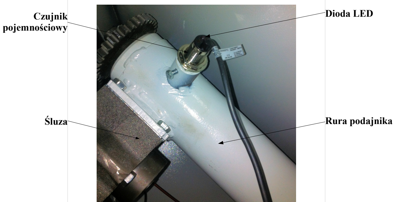
Rys nr 9. Umieszczenie pojemnościowego czujnika zbliżeniowego
