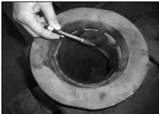
Rys. 10 Czyszczenie nagaru z kolana palnika (wyłącznie przy paliwie pellets)
