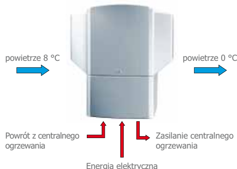
Przepływ powietrza przez pompę ciepła BWL-1-A
