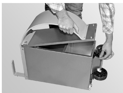
Rys. 139 Odbezpieczyć boczne klipsy zabezpieczające, ściągnąć pokrywę i opróżnić popielnik
