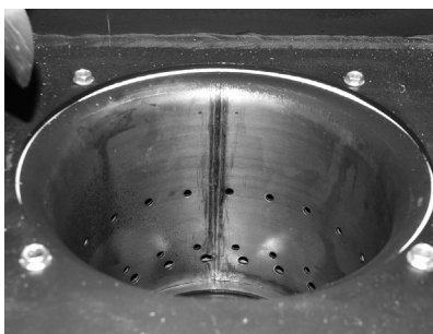
Rys. 153 Wyczyścić otwory powietrza wtórnego w palniku
